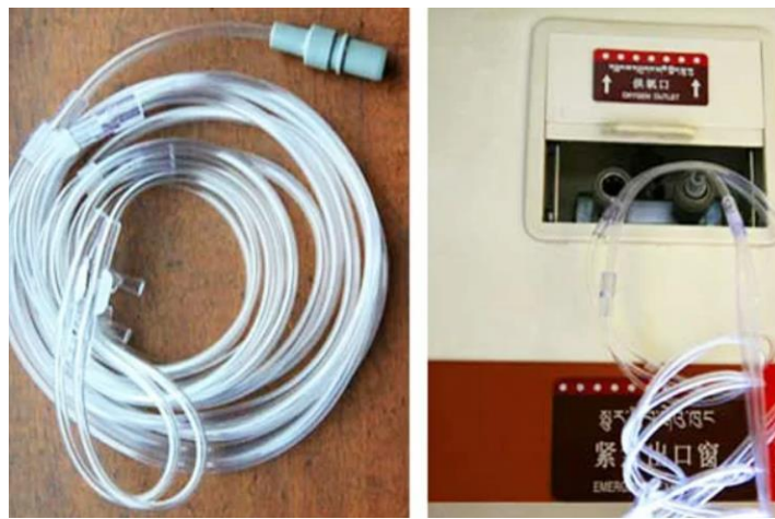
Slika 22 Pumpica za kisik kojom se služe putnici prilikom putovanja na određenim visinama (Izvor:[22]).
