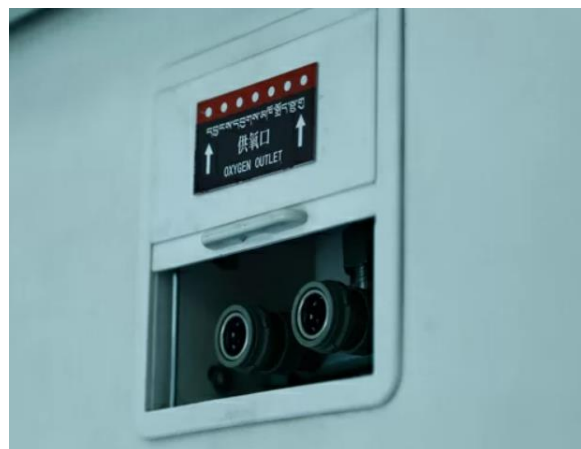
Slika 21 Ventil za kisik unutar vagona (Izvor: [22]).
