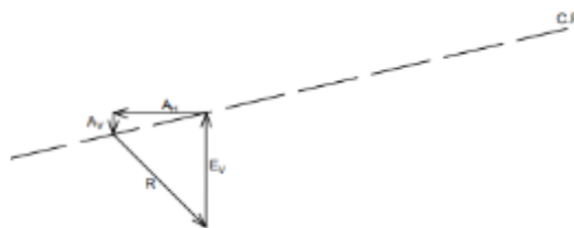
Slika 29. Određivanje reakcija Culmannovom metodom [10]
