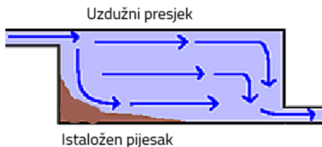
Slika 31: Shema kanalskog tipa pjeskolova (Izvor:[18])
