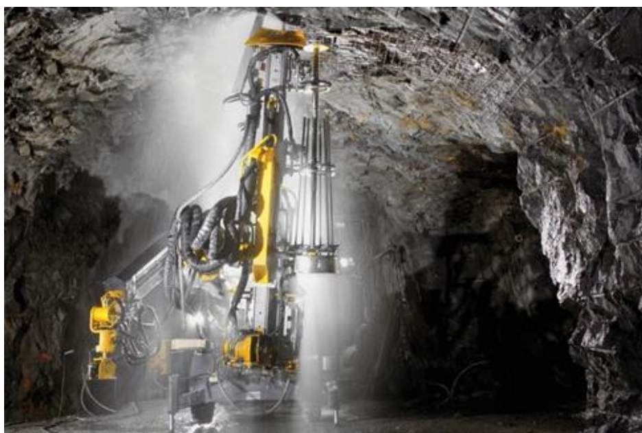
Slika 9.: Proces ugradnje štapnih sidara (Izvor: [21])
