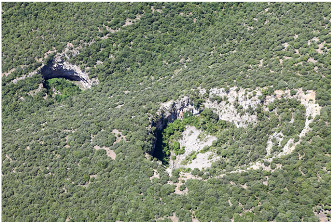
Slika 4 Urušne vrtače nastale urušavanjem krovne stijene, Sjeveroistočna Španjolska (Izvor: [5])
