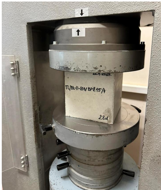
Slika 35. Ispitivanje tlačne čvrstoće lijevanoga betona s PDB-om nakon 28 dana
