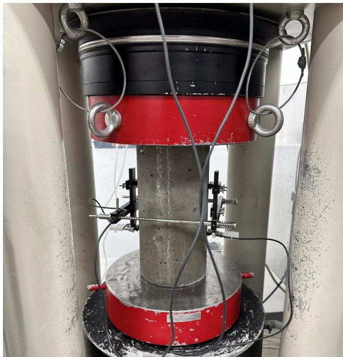
Slika 41. Ispitivanje modula elastičnosti lijevanog betona s PDB-pm
