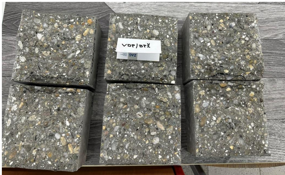
Slika 39. Mjerenje visine prodora bode uzoraka lijevanog betona s PDB-om
