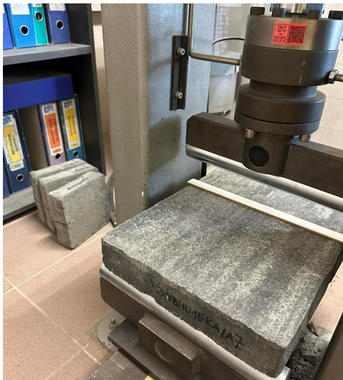
Slika 55. Ispitivanje čvrstoće na savijanje betonskih opločnika
