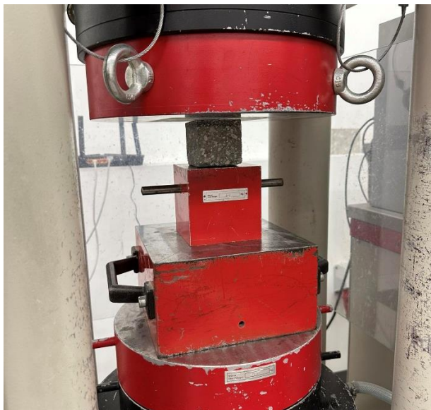
Slika 53. Ispitivanje tlačne čvrstoće betonskih opločnika
