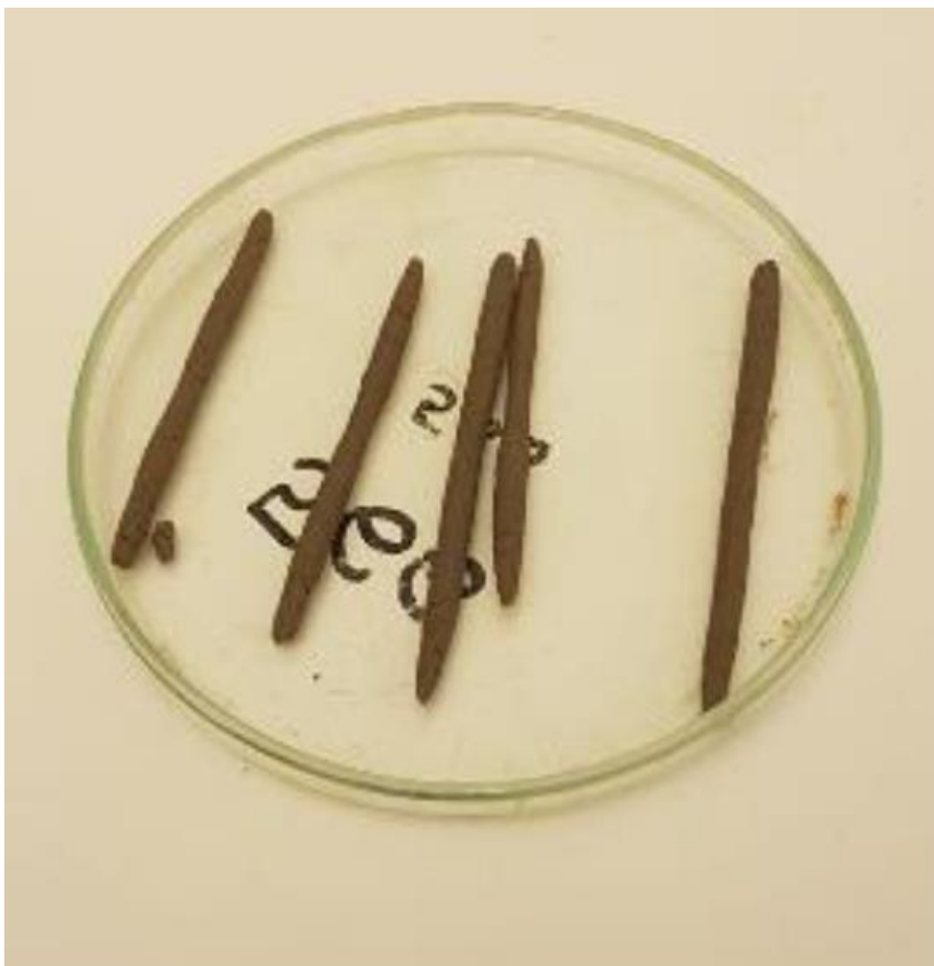
Slika 10 Valjčici za ispitivanje granice plastičnosti [5]
