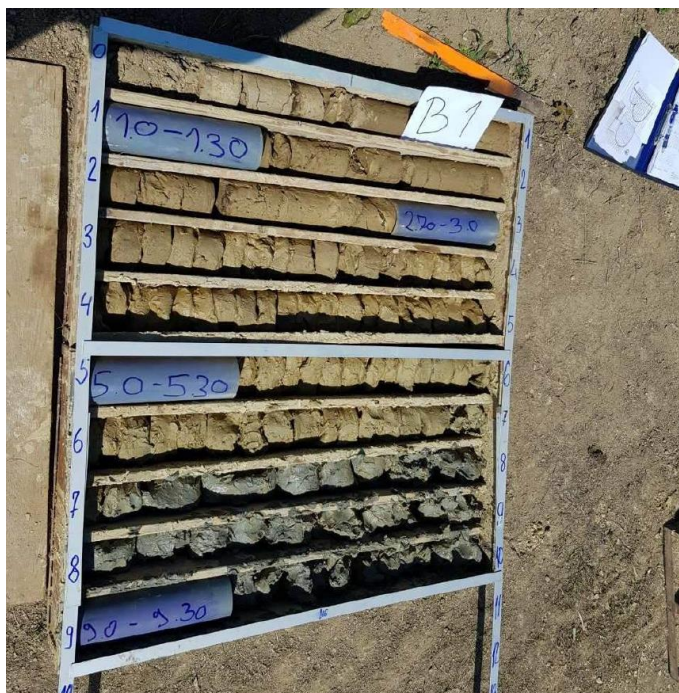
Slika 8 Primjer izvađene jezgre bušotine [4]
