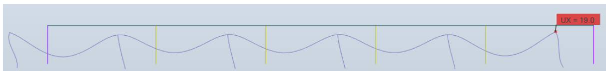
Slika 42. Pomak u smjeru x unutarnjeg okvira na dijelu prvog kata
