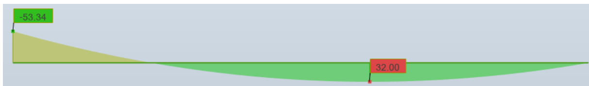
Slika 59. Momentni dijagram elementa
