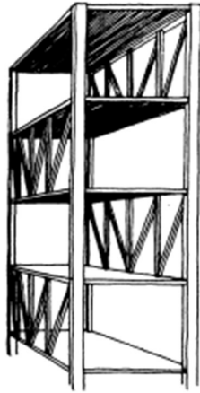
Slika 2. Prostorni prikaz rasporeda rešetki [4]
