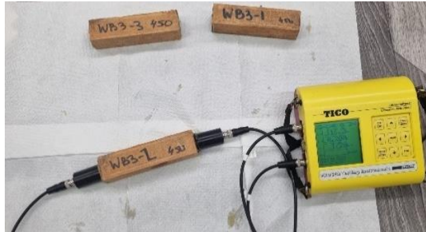
Slika 33: Mjerenje brzine prolaska ultrazvuka
