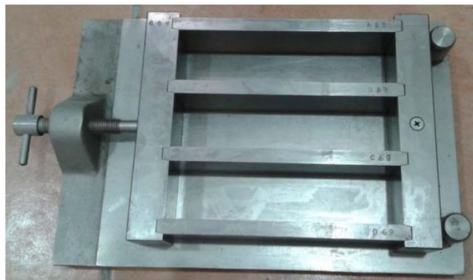
Slika 26: : Čelični kalup u koji je ugrađena mješavina [68]
