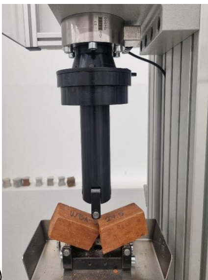
Slika 35: a) Uzorak WB u preši nakon loma
