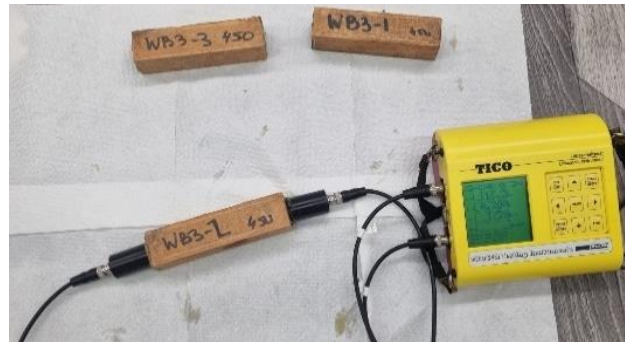
Slika 33: Mjerenje brzine prolaska ultrazvuka
