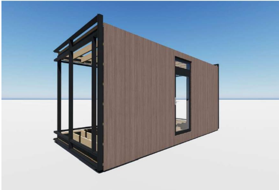
Slika 15. 1 strana izrađena od brodske šperploče debljine 15 mm, obložena tvrdim drvetom od termički modificiranog jasena. Vrata i prozori su s aluminijskim okvirom [32].
