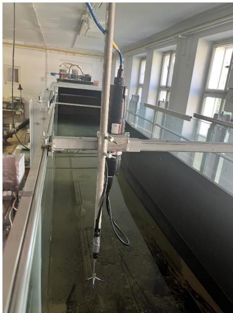
Slika 4.: Vectrino uređaj u laboratoriju (Autor: Lucija Zaplatić)
