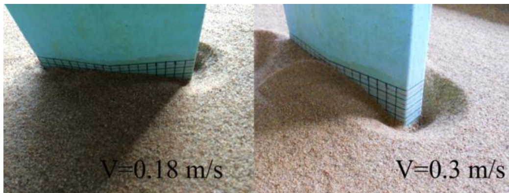
Slika 17. Jama podlokavanja za minimalnu i maksimalnu brzinu toka (heksagonalni stup)
