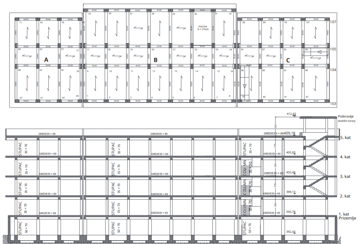
Slika 6.3 Tlocrt i presjek izvorne zgrade bolničkog centra u Avellinu (Ferraioli, Mandara, 2017).
