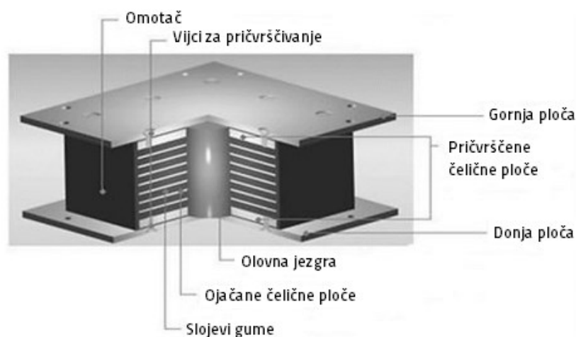
Slika 2.17 Dijelovi ležaja od olova i gume (Satya Sapath, Dash, 2018.)
