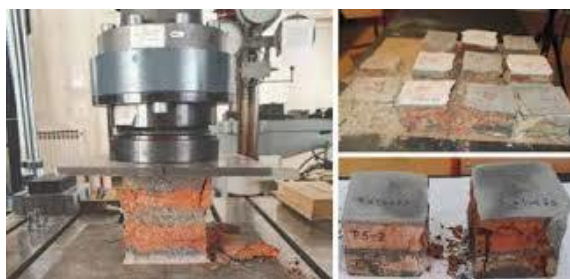
Slika 10. Ispitivanje tlačne čvrstoće opeke (Izvor: [14])
