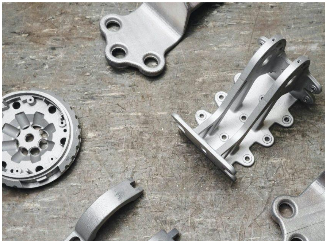
Slika 8.: Isprintani metalni dijelovi [7]
