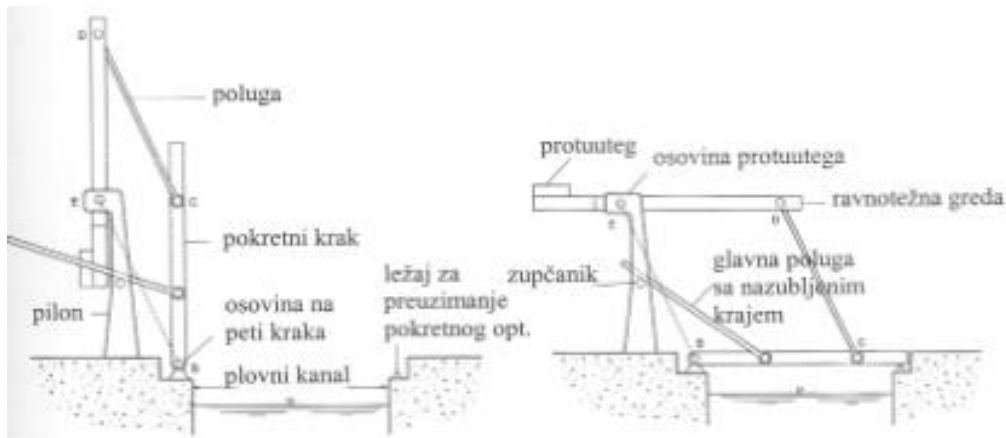
Slika 18.: Holandski tip rasklopnog mosta [2]
