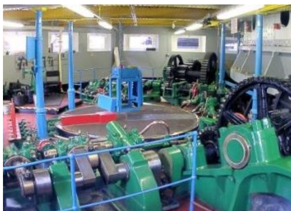
Slika 35.: Pokretni mehanizam na zaokretni mostu u Newcastle [15]
