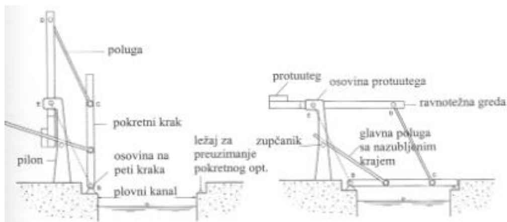
Slika 18.: Holandski tip rasklopnog mosta [2]
