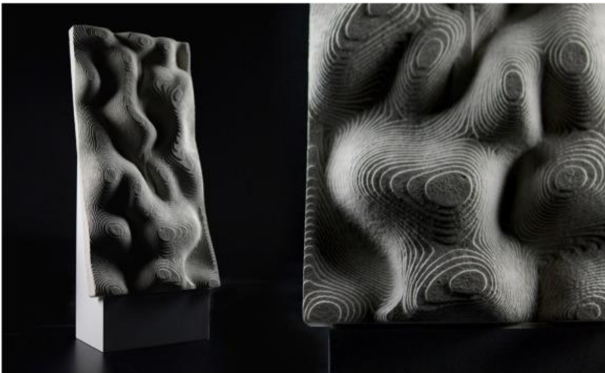
Slika 31: Primjer oblikovanja betona ledenom oplatom (Izvor [8.]
