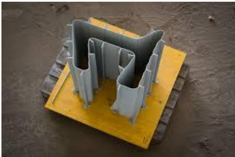
Slika 7: 3D isprintana oplata (Izvor [7.])
