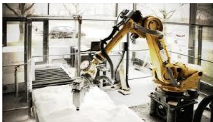
Slika 24: Izrada oplata CNC mašinom (Izvor [21.])
