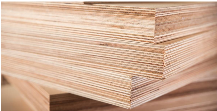
Slika 11: Presjek šperploče (Izvor [13.]
