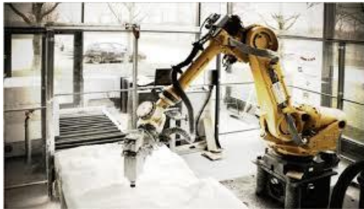
Slika 24: Izrada oplata CNC mašinom (Izvor [21.])
