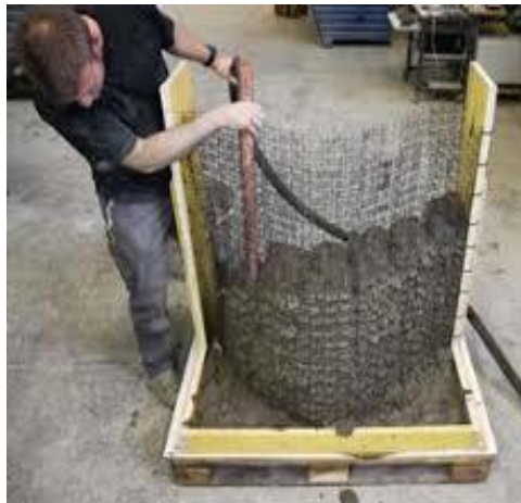
Slika 29: Punjenje mrežastog kalupa (Izvor [21.]
