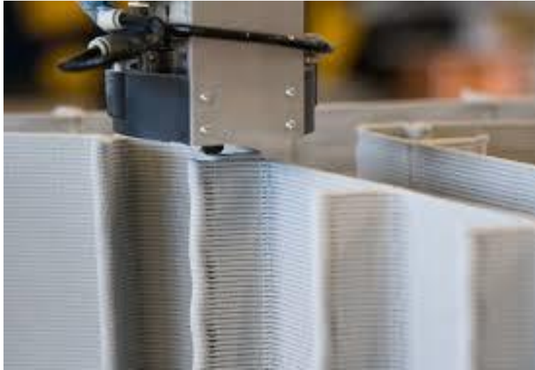
Slika 26: 3D printanje oplata (Izvor [23.]
