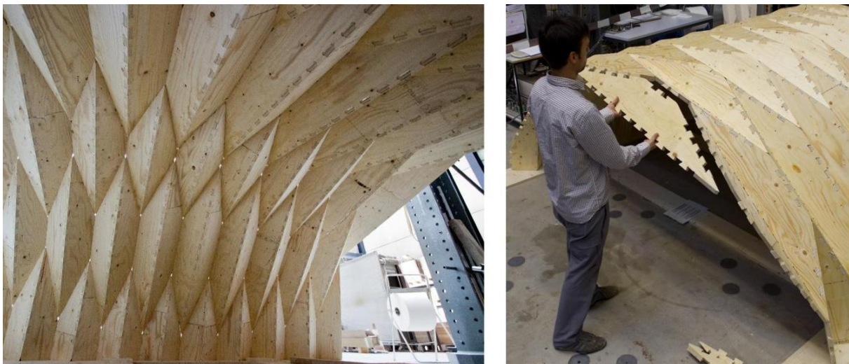
Slika 25: Oplata izrađena CNC mašinom (Izvor [22.])
