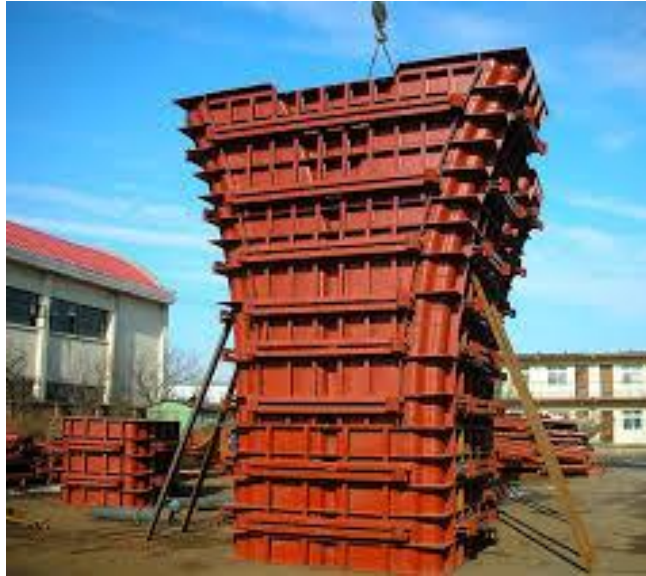
Slika 15: Čelična oplata stupa mosta (Izvor [17.])
