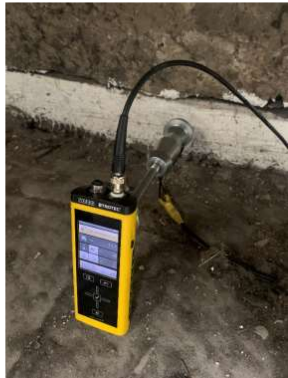
Slika 9. i Slika 10. Treće mjerenje vlagomjerom
