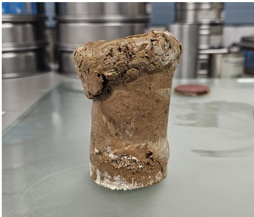
Slika 33. Razlomljeni uzorak nakon ispitivanja kod UU pokusa
