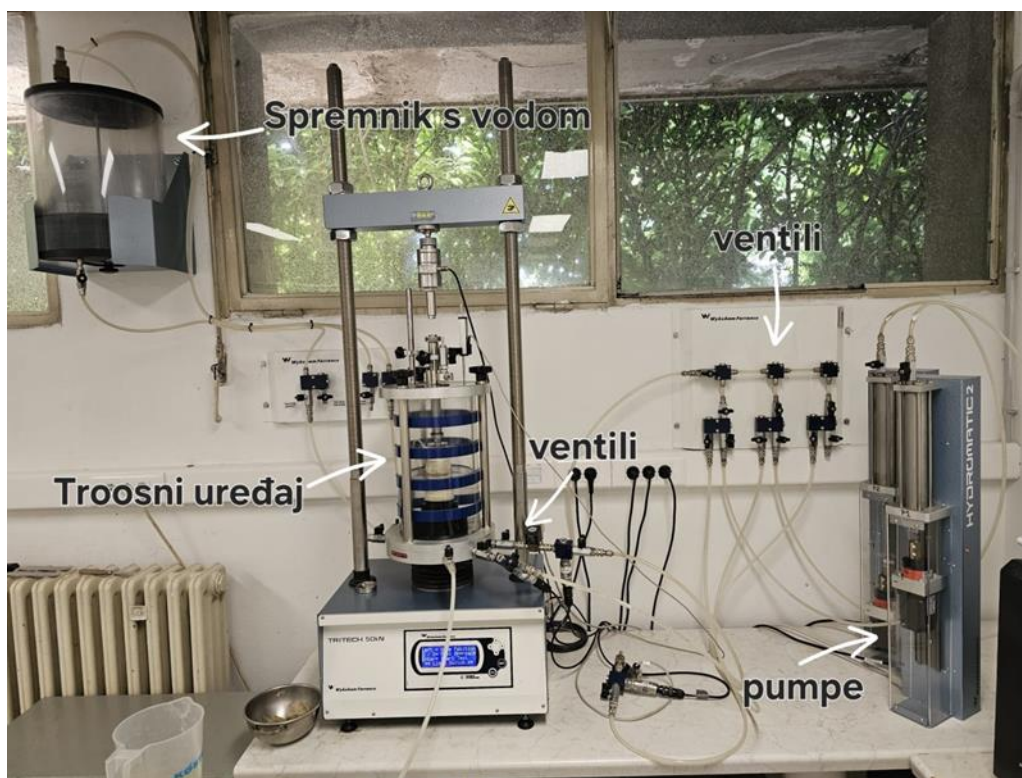
Slika 24. Uređaj za troosno ispitivanje
