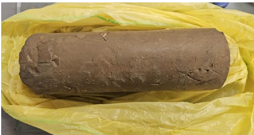
Slika 6. Neporemećeni istisnuti uzorak iz cijevi za uzorkovanje
