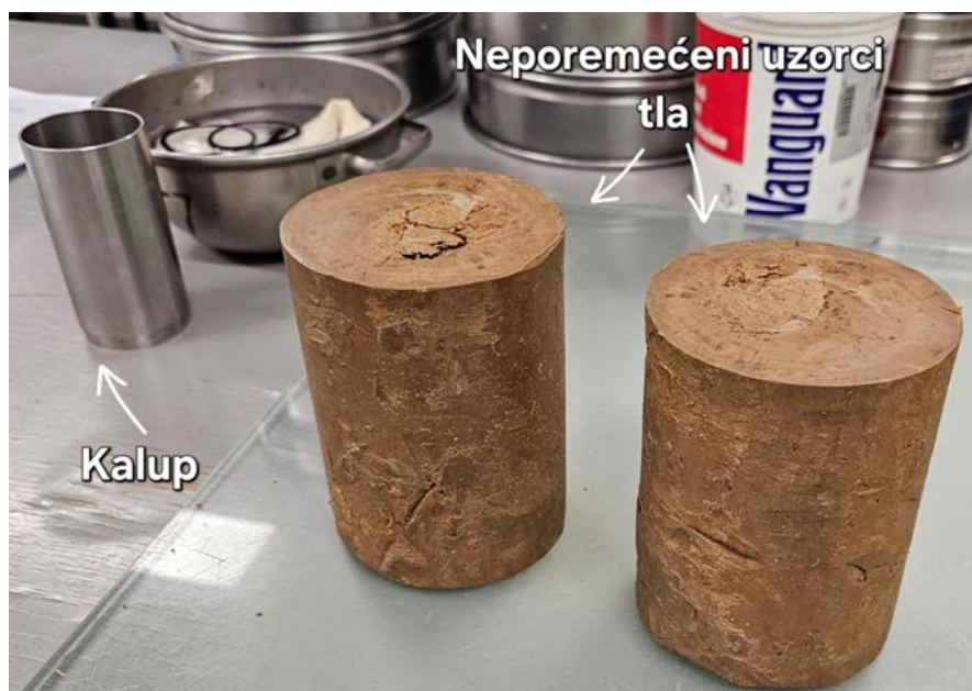
Slika 26. Uzorci tla i kalup za pripremu neporemećenih uzoraka za UU pokus
