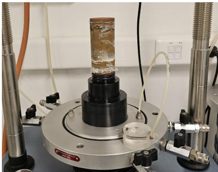
Slika 30. Uzorak namješten na postolje troosnog uređaja kod UU pokusa
