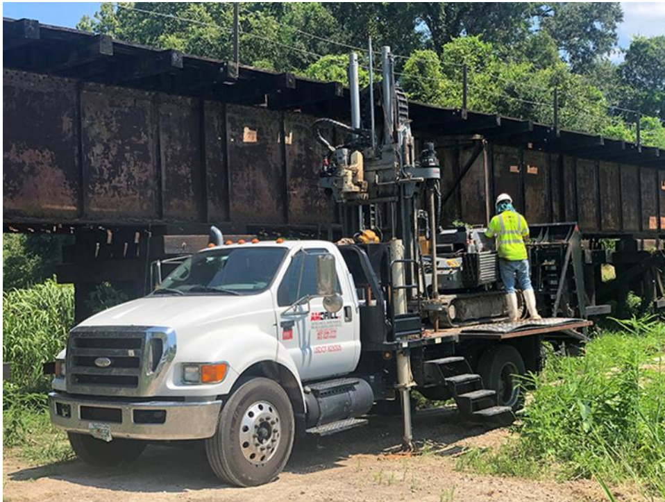
Slika 37. Oprema za CPT-teško vozilo [27]
