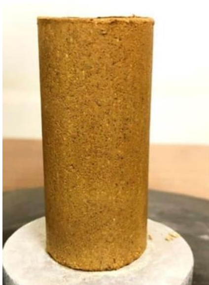
Slika 17. Uzorak tla pripremljen za pokus jednoosnog tlaka [17]
