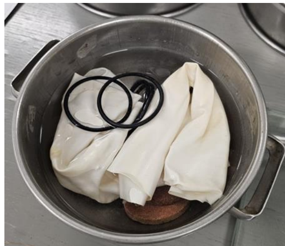
Slika 29. Saturacija membrane, poroznih pločica i O-prstenova za UU pokus
