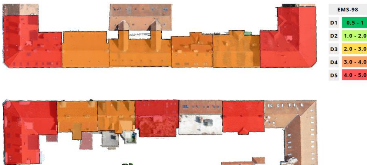
Slika 81.EMS 98 razred oštećenja za intenzitet VIII
