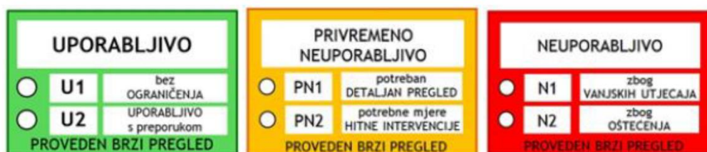
Slika 6: Prikaz grafičkih oznaka građevina nakon potresa
