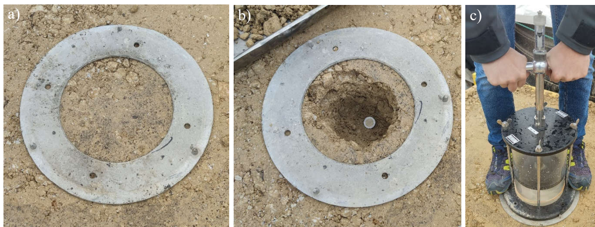
Slika 7-12 Određivanje volumena volumometrom: a) podnožna ploča, b) rupa u koju se utiskuje balon; c) volumometar
