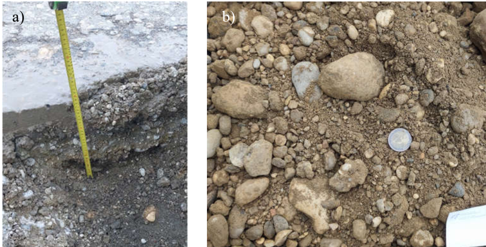
MNS na lokaciji 8: a) debljina sloja; b) materijal izvađen iz sloja
