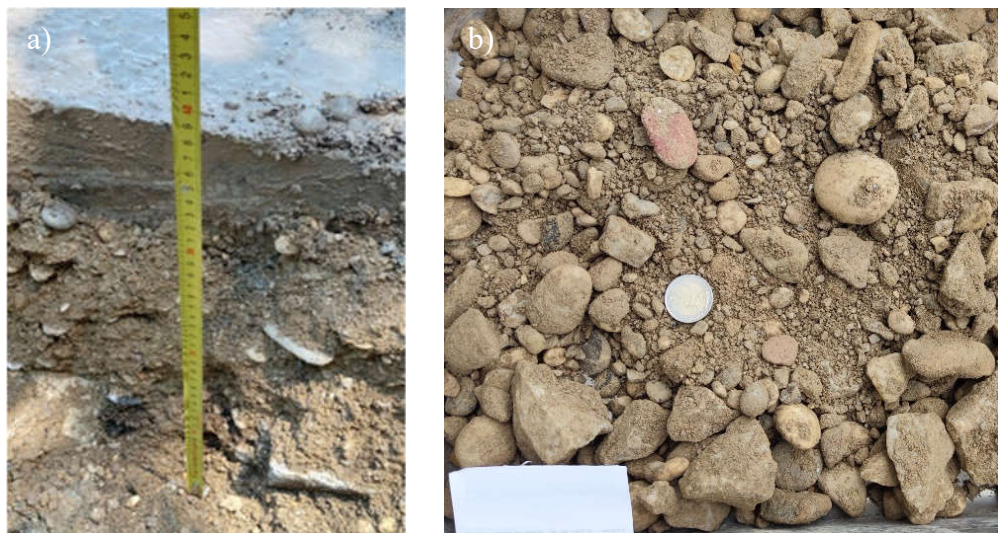
MNS na lokaciji 24: a) debljina sloja; b) materijal izvađen iz sloja
