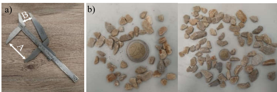
Slika 6-5 Određivanje oblika zrna: a) kljunasto mjerilo; b) zrna nepovoljnog oblika
