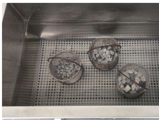
Slika 6-10 Ispitivanje otpornosti na smrzavanje metodom natrijevog sulfata
