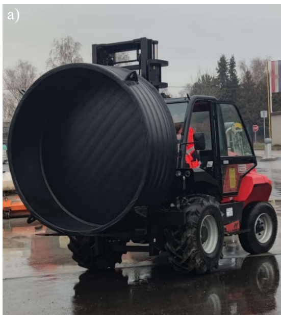
Slika 7-3 Kalupi: a) izrađen od PE cijevi s dnom od HDPE ploče; b) izrađen od oplatnih ploča
