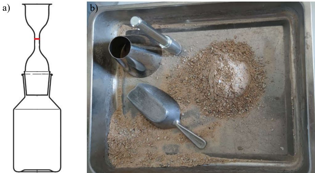
Slika 6-9 Određivanje gustoće i upijanje vode: a) piknometar; b) određivanje površinski suhog stanja uzorka frakcije 0,063/4 mm
