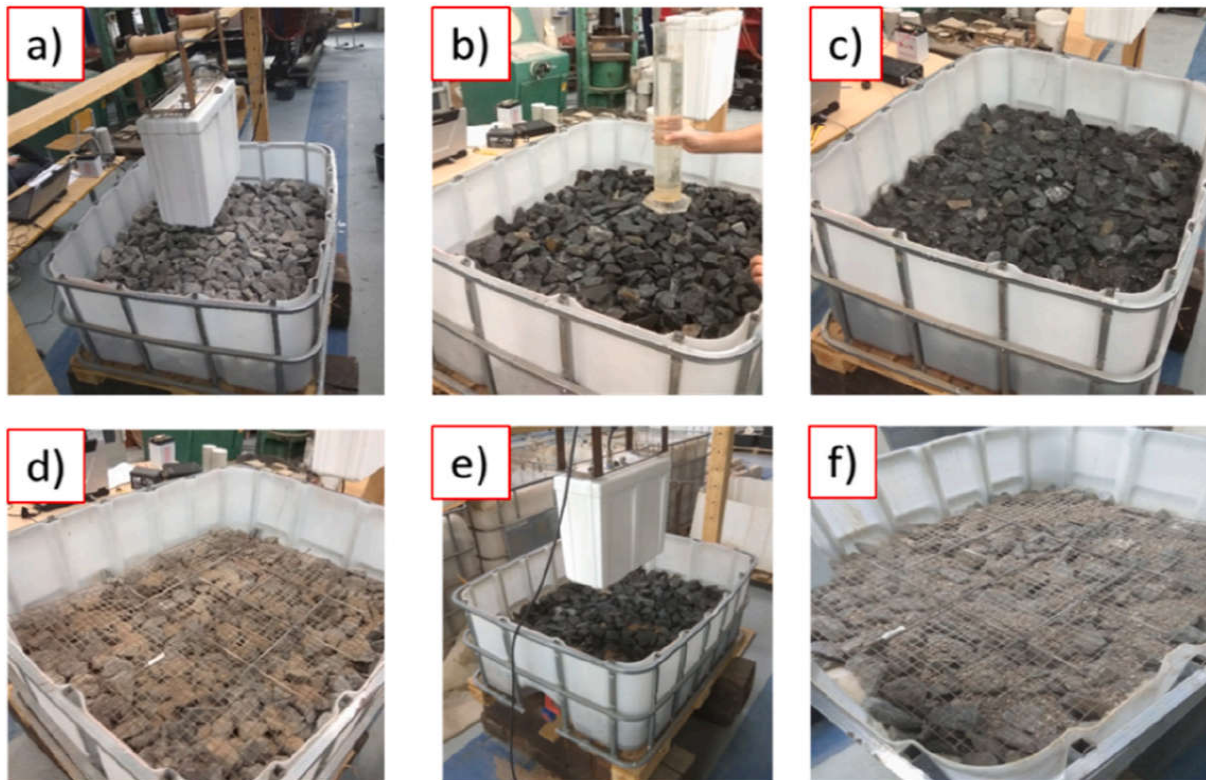
Slika 3-15 Uzorci zastorne prizme [188]: a) čisti suhi agregat; b) čisti agregat s dodanom vodom; c) čisti agregat potpuno saturirani; d) agregat s dodanim pijeskom; e) vlažni mješavina čistog agregata i pijeska; f) čisti agregat s dodanim šljunkom
