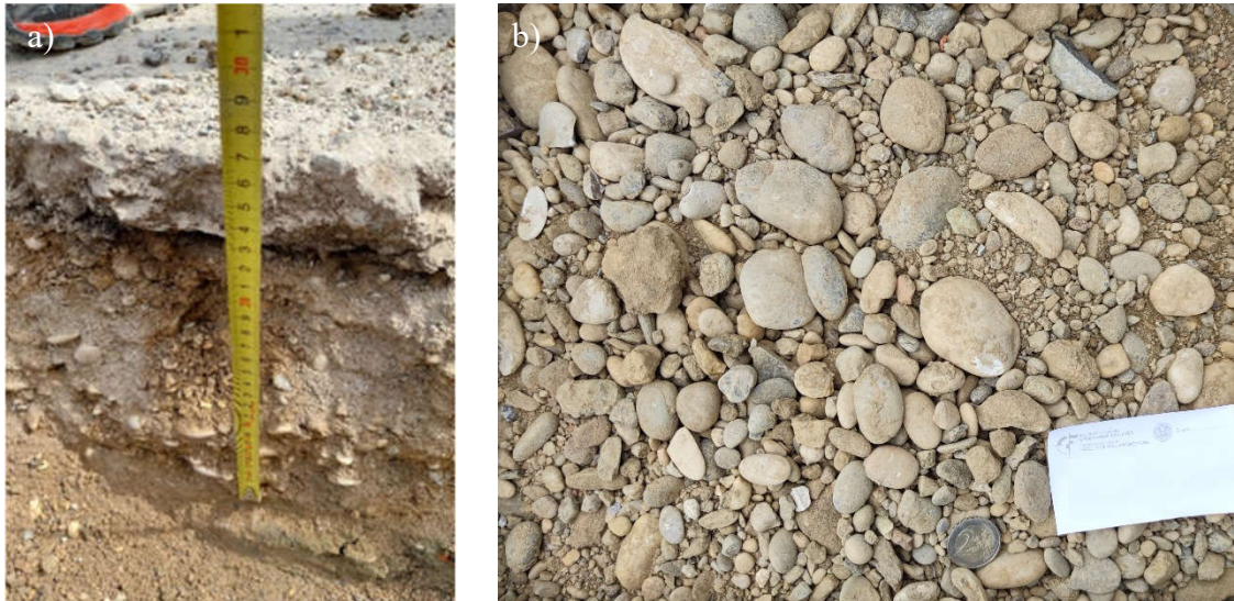
MNS na lokaciji 17: a) debljina sloja; b) materijal izvađen iz sloja
