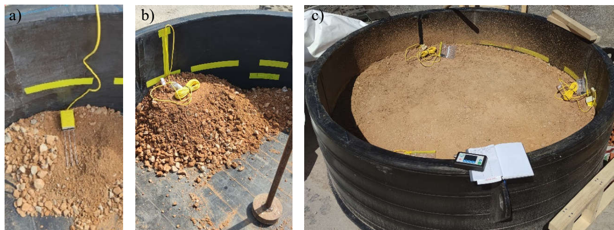
Slika 7-5 Instalacija TDR sonde: a) postavljanje sonde na određenoj dubini; b) primarno ručno zbijanje; c) uzorak s tri ugrađene sonde
