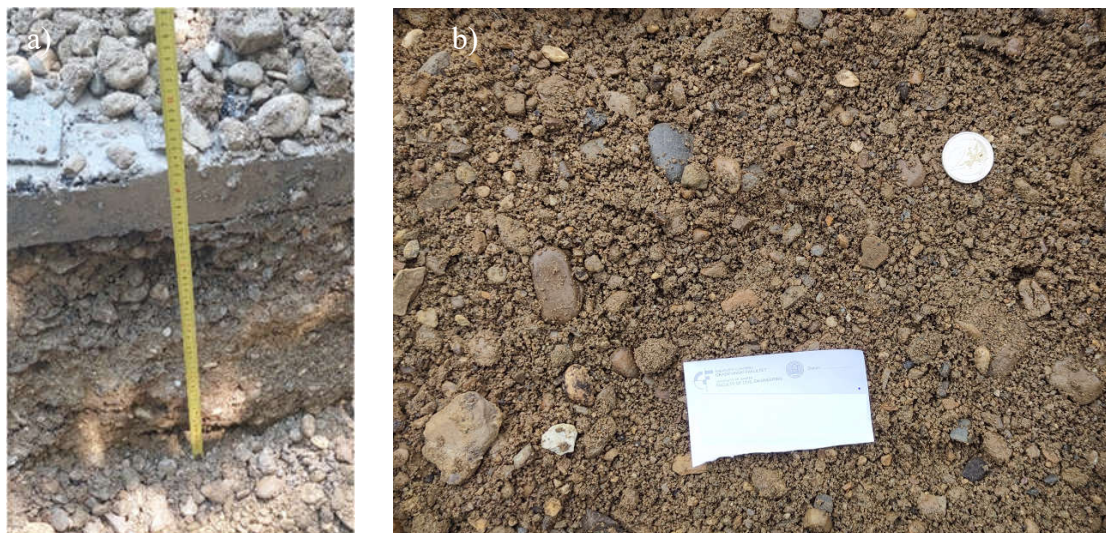
MNS na lokaciji 23: a) debljina sloja; b) materijal izvađen iz sloja
