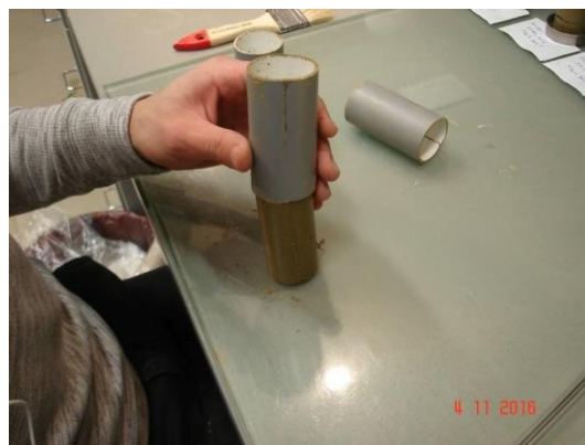
Slika 7.9. Vađenje uzorka iz kalupa
