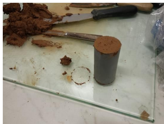
Slika 7.7. Formiranje uzorka, stavljanje smjese gline i veziva u plastični kalup
