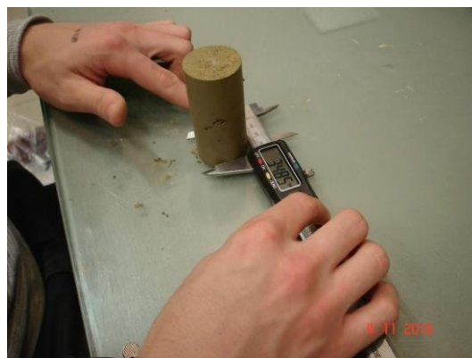
Slika 7.11. Mjerenje promjera uzorka na vrhu i dnu u dva okomita smjera
