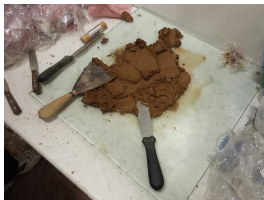
Slika 7.6. Spravljanje (miješanje) kompozitne smjese gline i veziva
