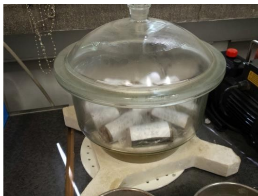
Slika 7.8. Označavanje uzoraka i čuvanje u staklenom desikatoru
