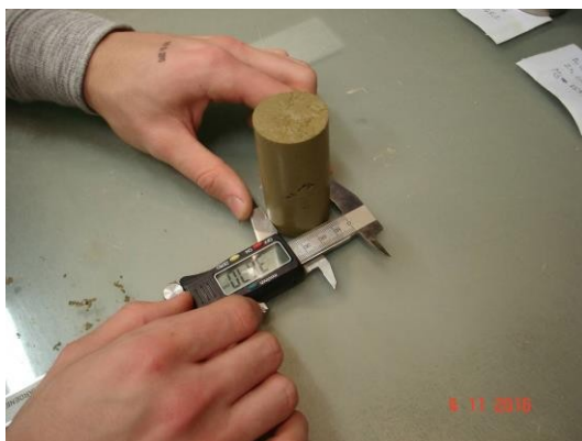
Slika 7.11. Mjerenje promjera uzorka na vrhu i dnu u dva okomita smjera
