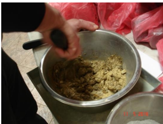
Slika 7.6. Spravljanje (miješanje) kompozitne smjese gline i veziva
