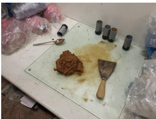
Slika 7.7. Formiranje uzorka, stavljanje smjese gline i veziva u plastični kalup
