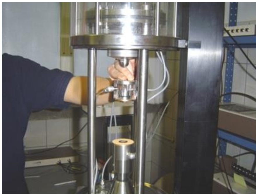
Slika 6.9. Bender elementi tvrtke GDS u troosnom uređaju Zavoda za geotehniku Građevinskog fakulteta Sveučilišta u Zagrebu (Lebo, 2011)
