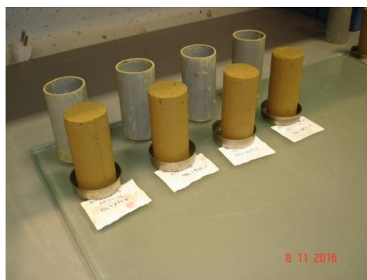
Slika 7.10. Izvađeni uzorci iz kalupa pripremljeni za mjerenje i vaganje
