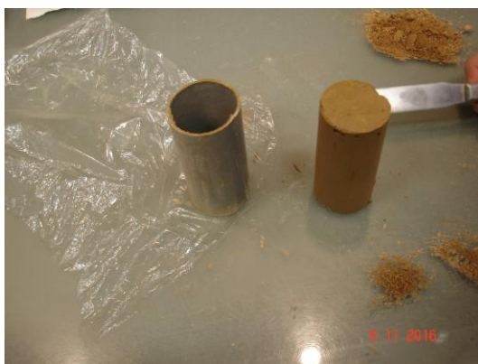
Slika 7.10. Izvađeni uzorci iz kalupa pripremljeni za mjerenje i vaganje
