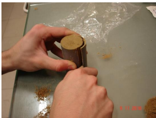
Slika 7.9. Vađenje uzorka iz kalupa
