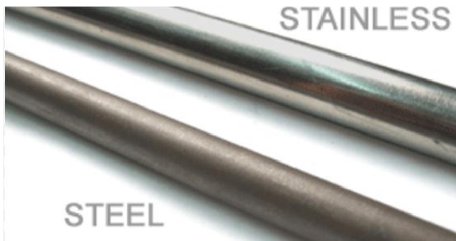
Slika 24.: Primjer izgleda nehrđajućeg i običnog čelika [31]
