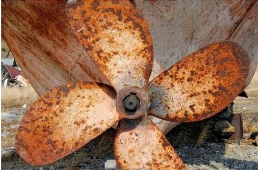
Slika 6.: Primjer selektivne korozije [10]
