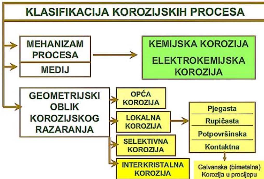
Slika 2.: Klasifikacija korozijskih procesa [6]
