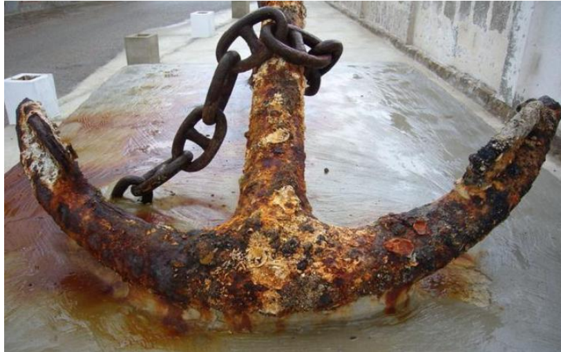
Slika 4.: Primjer elektrokemijske korozije [8]
