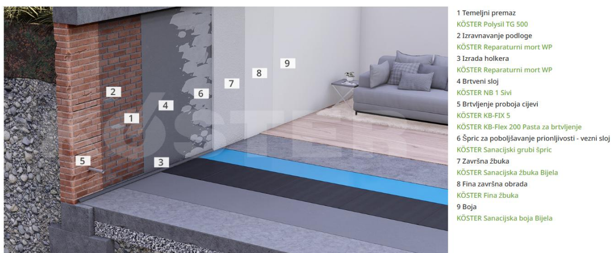
Slika 16 Sustav za brtvljenje podruma iznutra u slučaju vlage iz tla [15]
