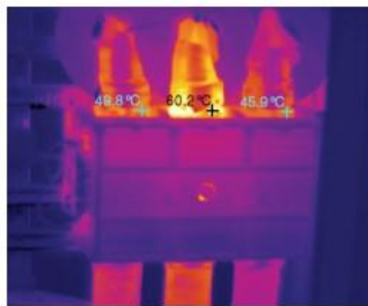
Slika 11. Temperaturna raspodjela elemenata električnih instalacija - kvantitativna termografija [1]
