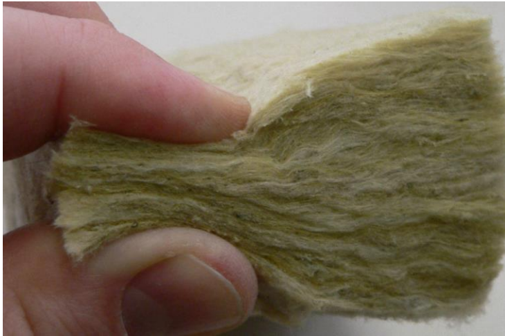
Slika 1 Prikaz presjeka mineralne vune (Wikipedia)
