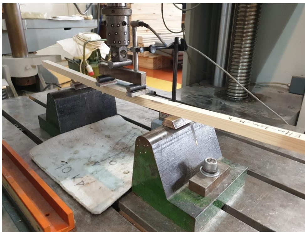
Slika 3.32 Početak ispitivanja – uzorak dimenzija 20 \times 20 mm
