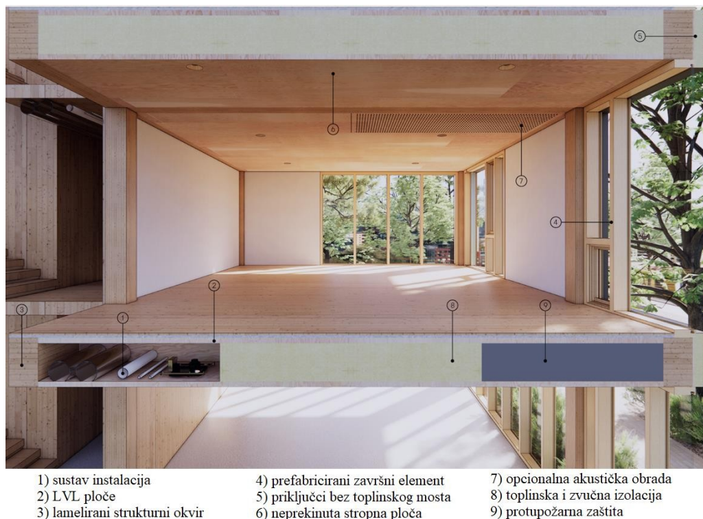
Slika 2.14 Dijelovi sustava Fabric
