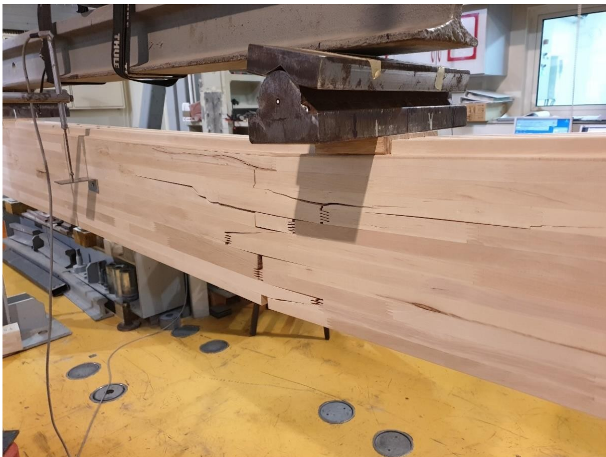
Slika 3.38 Savijanje oko jače osi- pucanje tvrdog drva po zupčastom spoju
