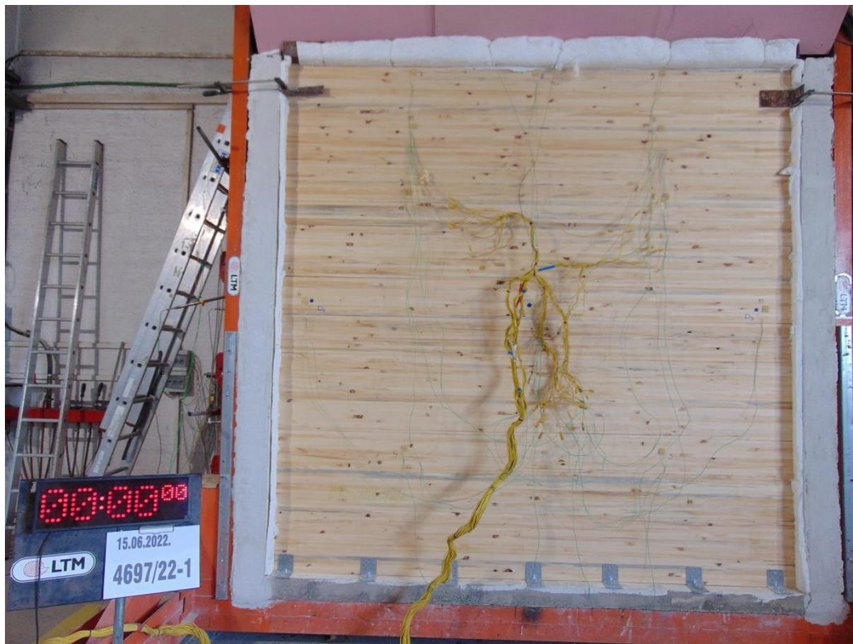
Slika 4.110 Ispitni uzorak s neizložene strane prije ispitivanja
