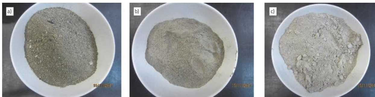
Slika 14. Uzorci pepela drvne biomase: a) pepeo s dna peći; b) leteći pepeo krupnije frakcije; c) finiji leteći pepeo [5]
