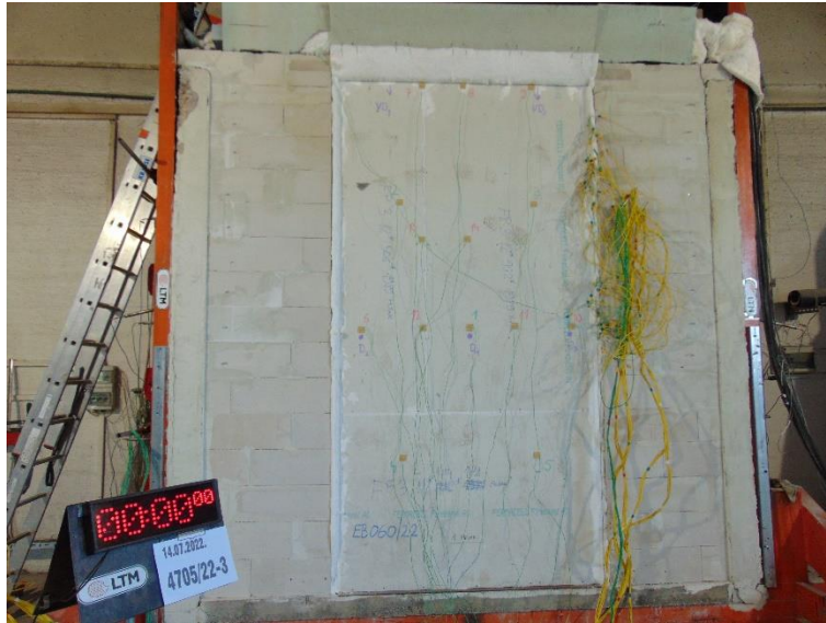
Slika 44. PANEL 1 prije ispitivanja otpornosti na požar
