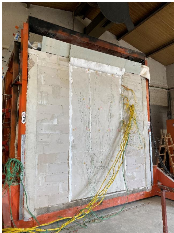
Slika 41. Ispitna požarna peć
