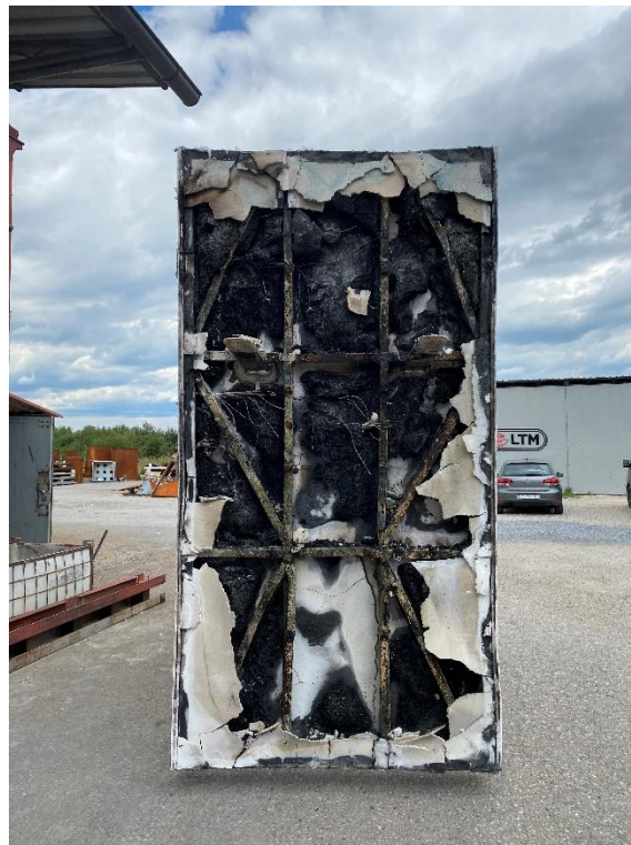
Slika 47. PANEL 2 nakon ispitivanja otpornosti na požar
