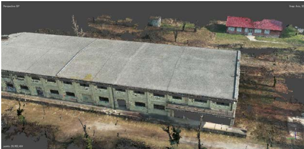
Slika 22 Model dobiven inicijalnim preletom
