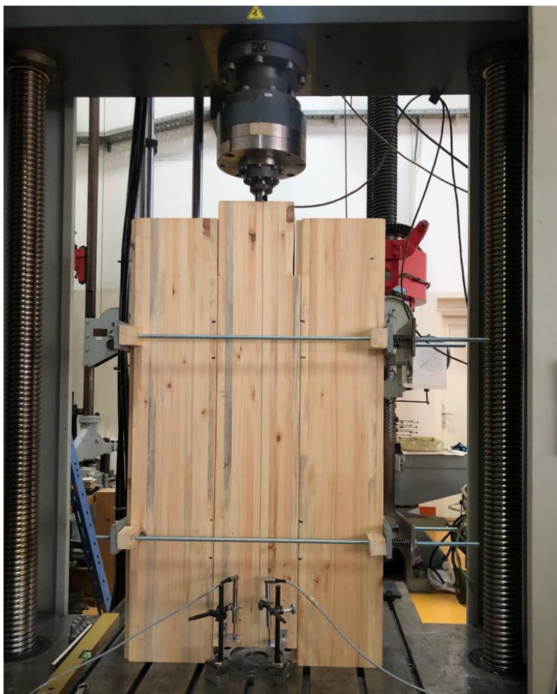
Slika 10. Uzorak za ispitivanje konstrukcijskog sklopa
