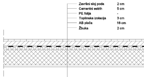
Slika 2.1. : Presjek međukatne konstrukcije
