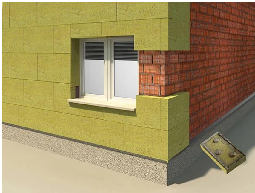
Slika 16. Postavljanje kamene vune
