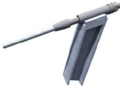
Slika 36. Spoj užeta s čeličnim stupom
