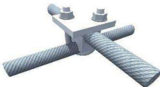
Slika 33. Spoj dvosmjernog sustava kablova
