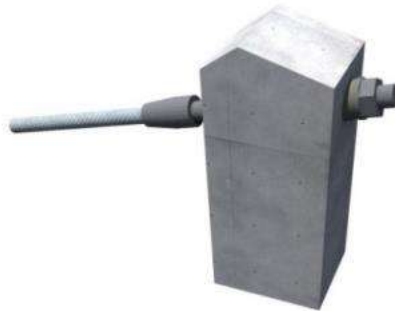
Slika 37. Spoj užeta s betonskim stupom
