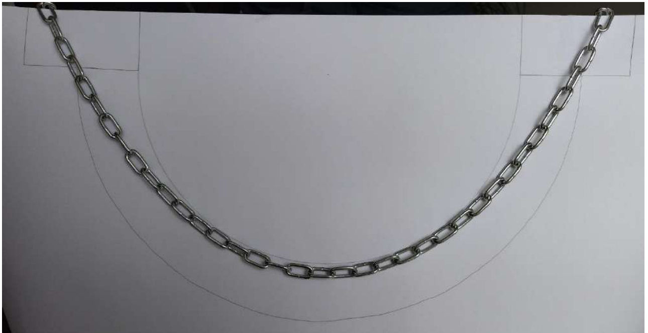
Slika 30. Tlačna linija kod smanjenja raspona
