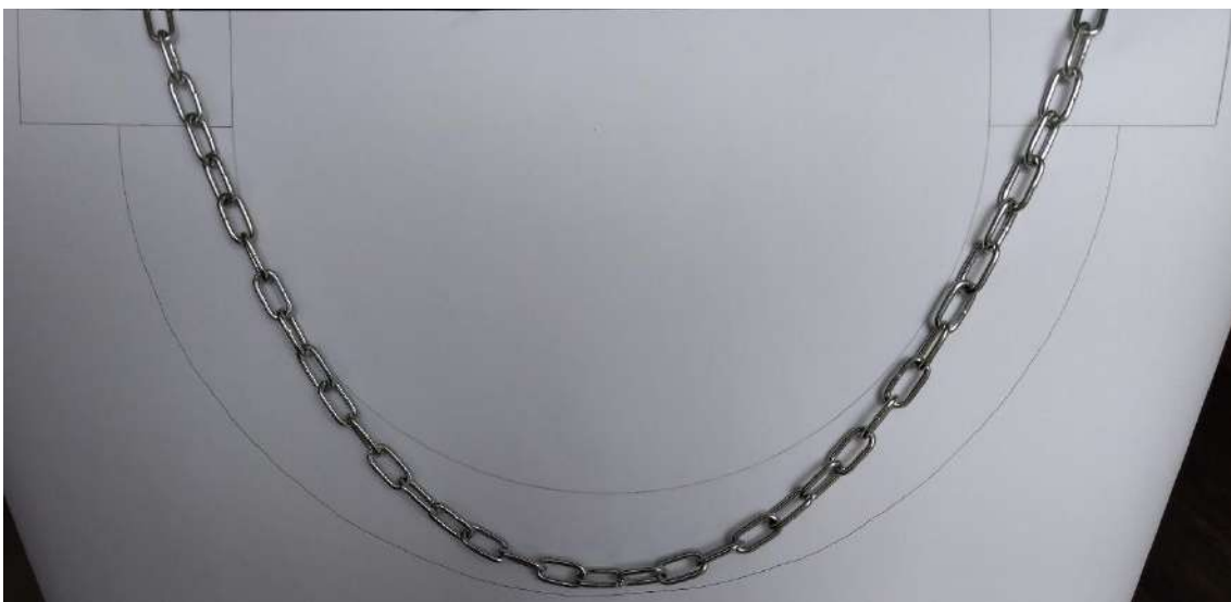
Slika 28. Tlačna linija kod povećanja raspona
