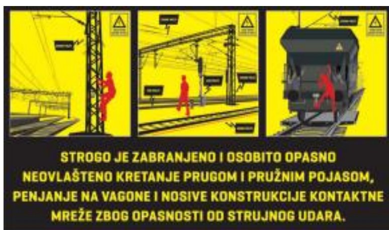
Slika 19. Znak upozorenja na opasnost od strujnog udara
