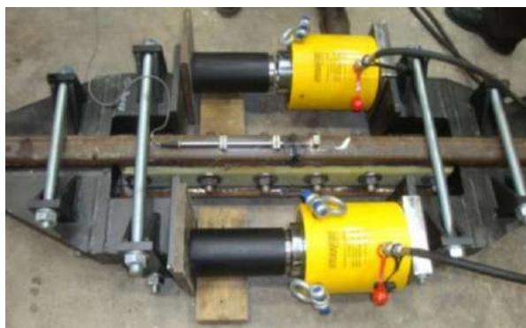
Slika 4.23. Vlačno ispitivanje izoliranih spojeva tračnica [29]
