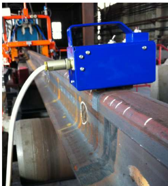
Slika 4.16. Defektoskop na bazi magnetskog toka [21]
