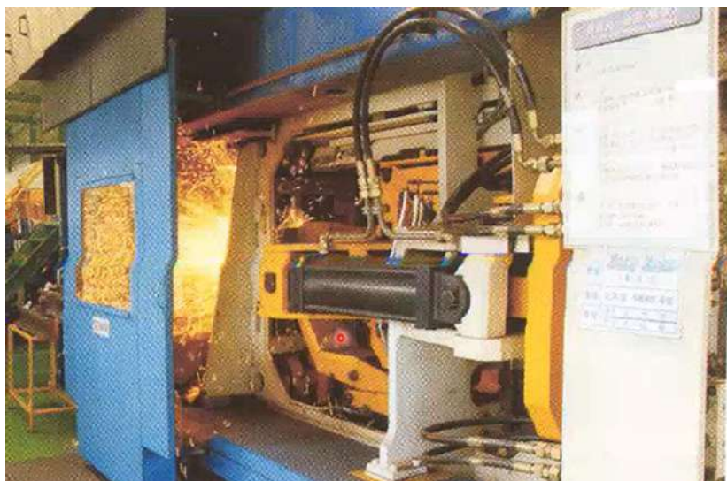
Slika 3.8. Elektrootporno zavarivanje u radionici [10]
