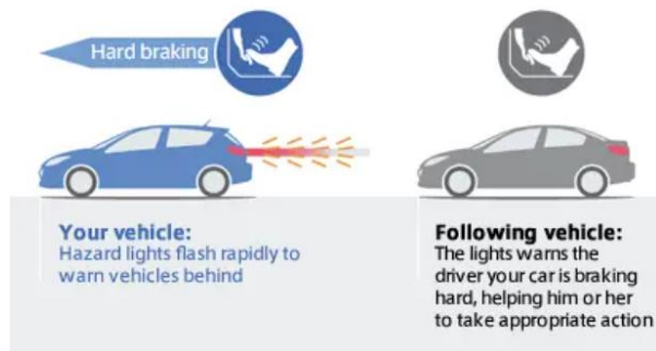
Slika 9. Prikaz rada signala za zaustavljanje u nuždi [16]
