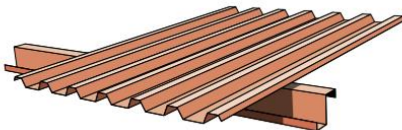
Slika 13. Jednoslojni krov od profiliranog lima
