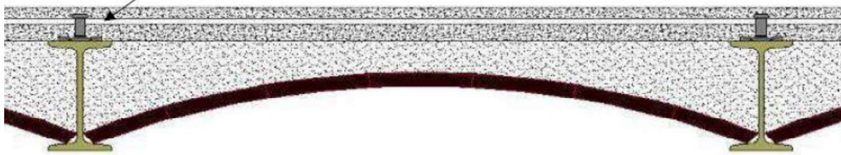
Slika 37 Presjek tlačne ploče 2.kata(Tarnik,2022)
