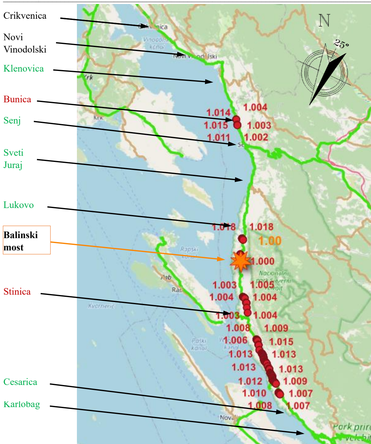
Slika 4.5 Točke sa većim brzinama od one na Balinskom mostu pri smjeru vjetra od 25°
