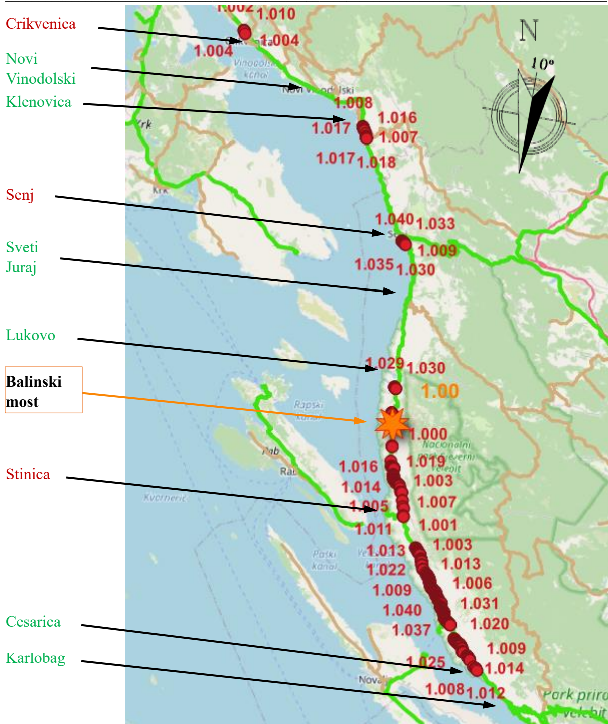
Slika 4.2 Točke sa većim brzinama od one na Balinskom mostu pri smjeru vjetra od 10°
