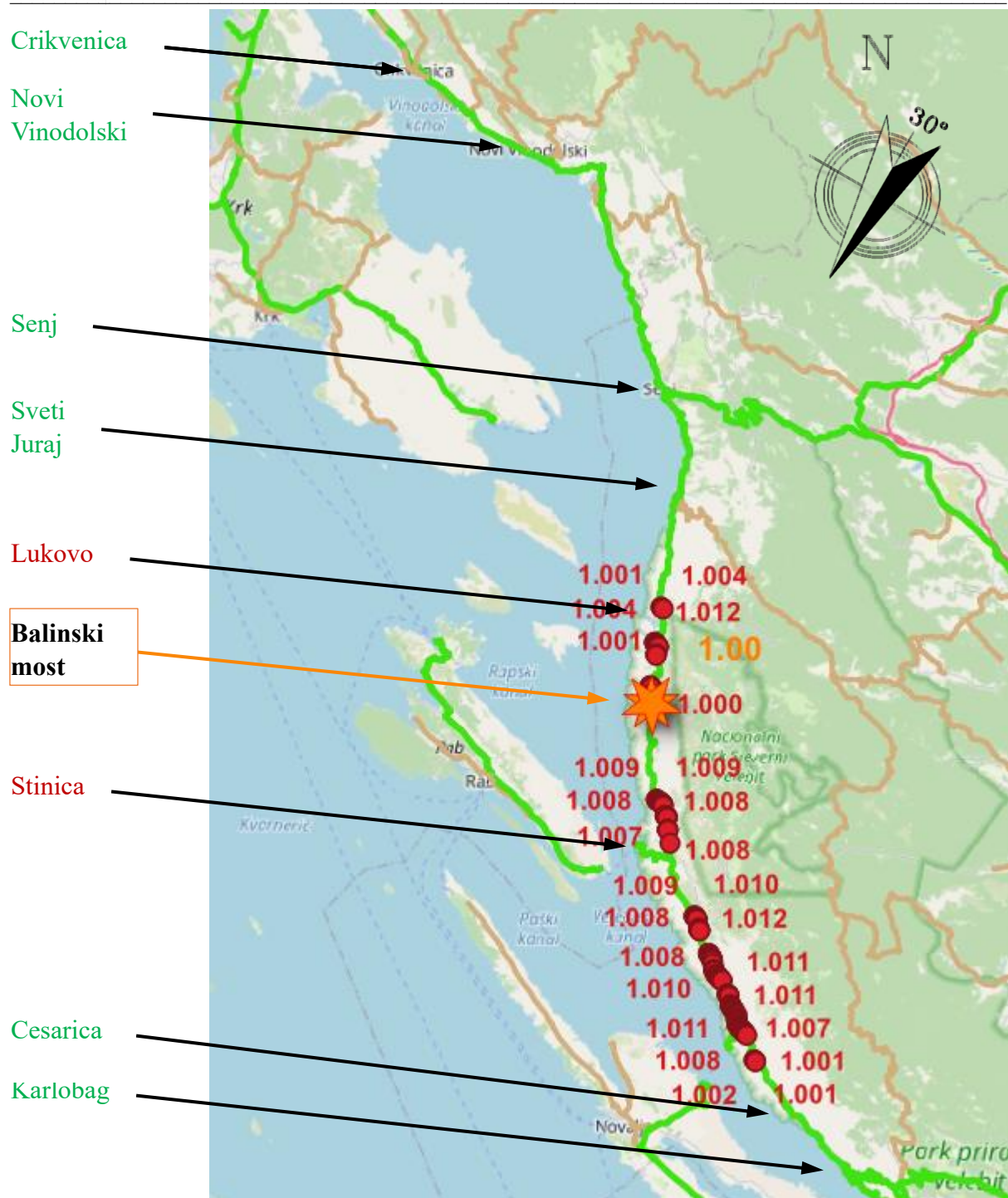
Slika 4.6 Točke sa većim brzinama od one na Balinskom mostu pri smjeru vjetra od 30°
