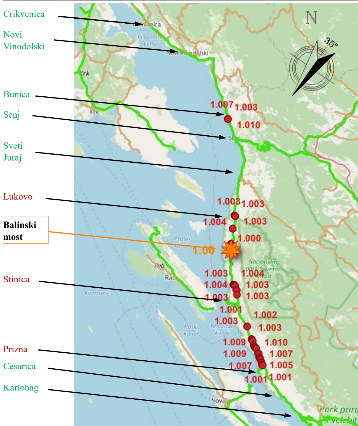
Slika 4.7 Točke sa većim brzinama od one na Balinskom mostu pri smjeru vjetra od 35°
