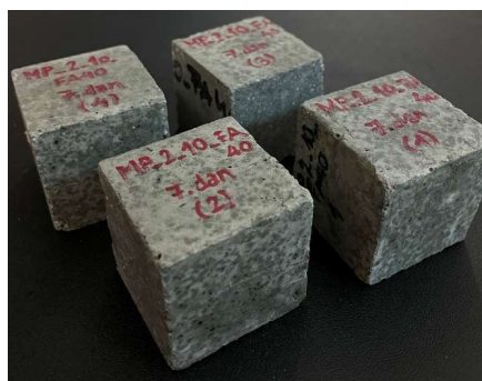
Slika 26. Uzorci Mix3 nakon raskalupljivanja.
