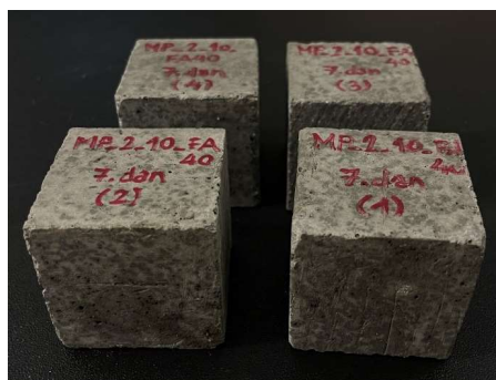
Slika 26. Uzorci Mix3 nakon raskalupljivanja.
