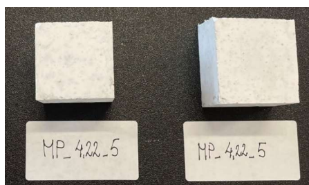
Slika 24. Uzorci EMix1 nakon raskalupljivanja.
