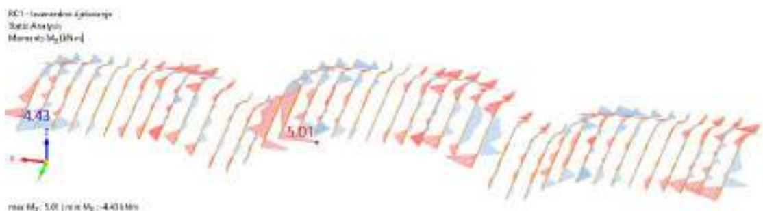
Slika 6.5 Dijagram momenata savijanja M_z [kNm]
