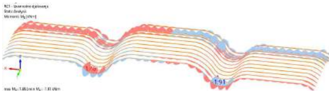
Slika 6.13 Dijagram momenata savijanja M_z [kNm]
