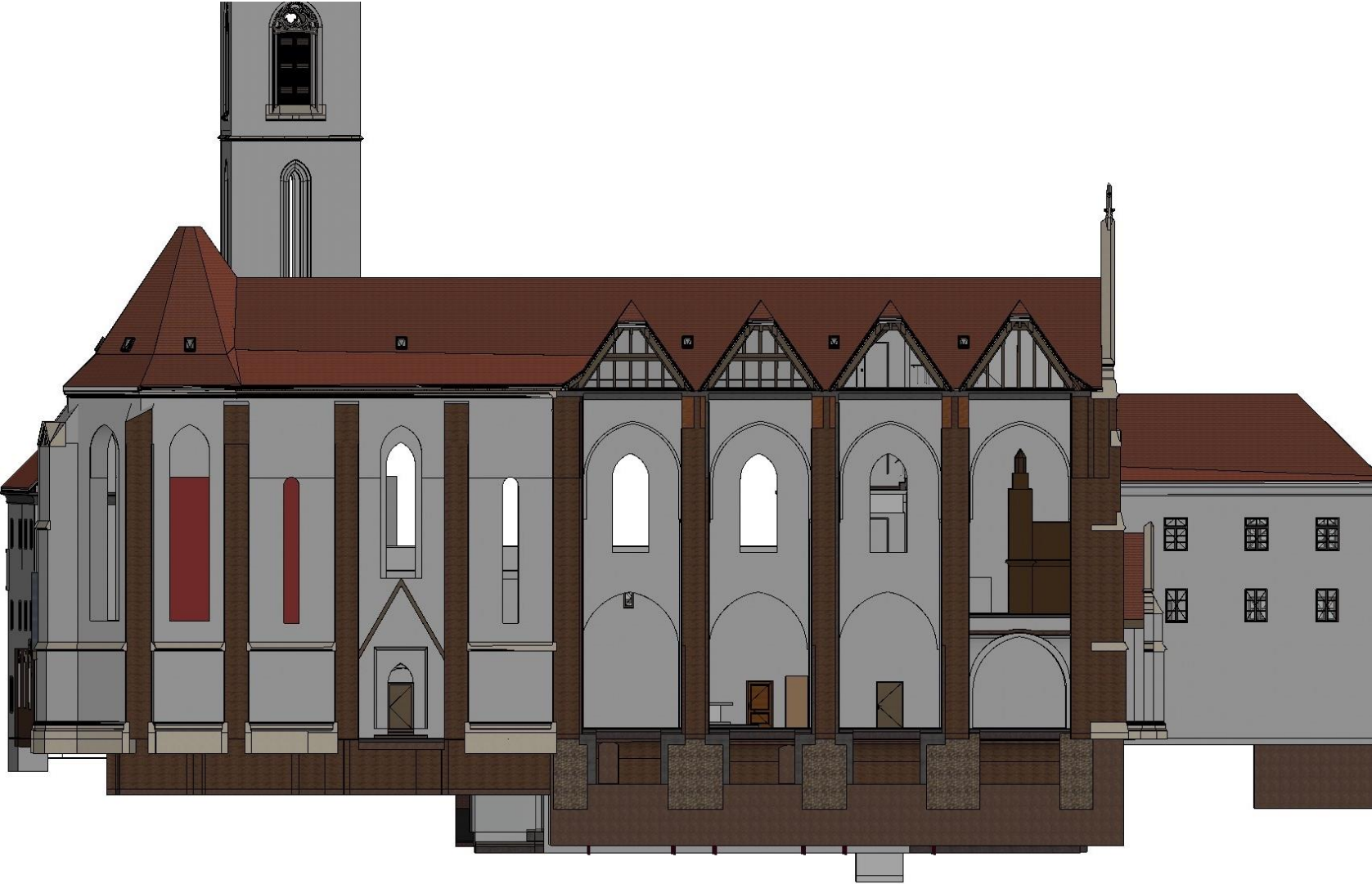
Prilog 2: Uzdužni presjek crkve sv. Franje Asiškog u 3D BIM modelu
