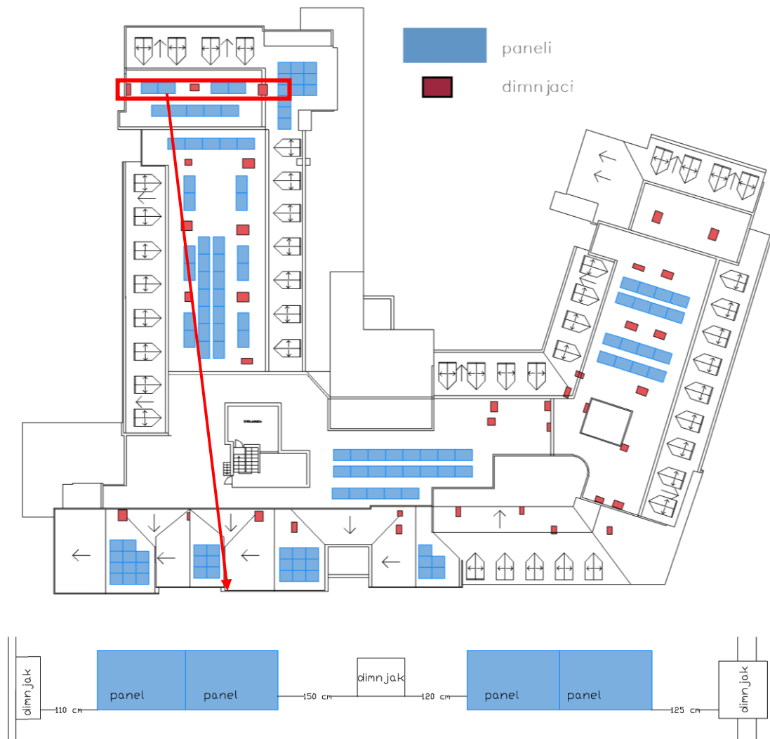
Slika 46 Položaj dimnjaka u odnosu na panele
