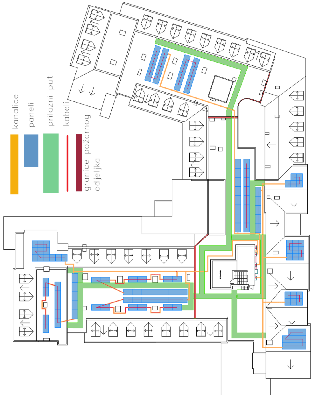
Prilog 7: Idejno rješenje sunčane elektrane
