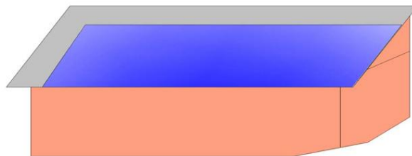
Slika 30 Primjer kada pristup krovu ili ispod krova nije moguć kroz prozor ili direktno s terena (33)
