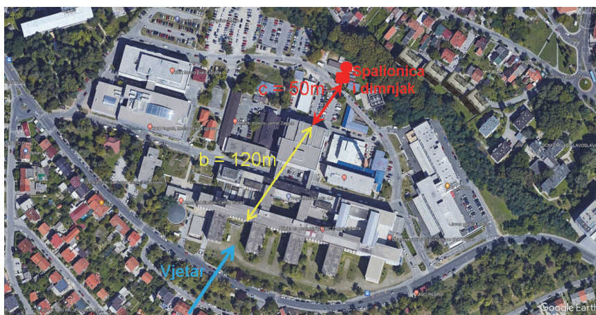
Slika 2. Prikaz karakterističnih dužina za KBC-Rebro u smjeru djelovanja vjetra iz SW smjera
