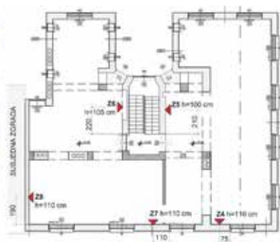
Slika 3. Stambeno-poslovna građevina, Ulica Ivana Dežmana 9 u Zagrebu (lijevo), tlocrt 3. kata s označenim mjestima ispitivanja posmične čvrstoće ziđa (desno)
