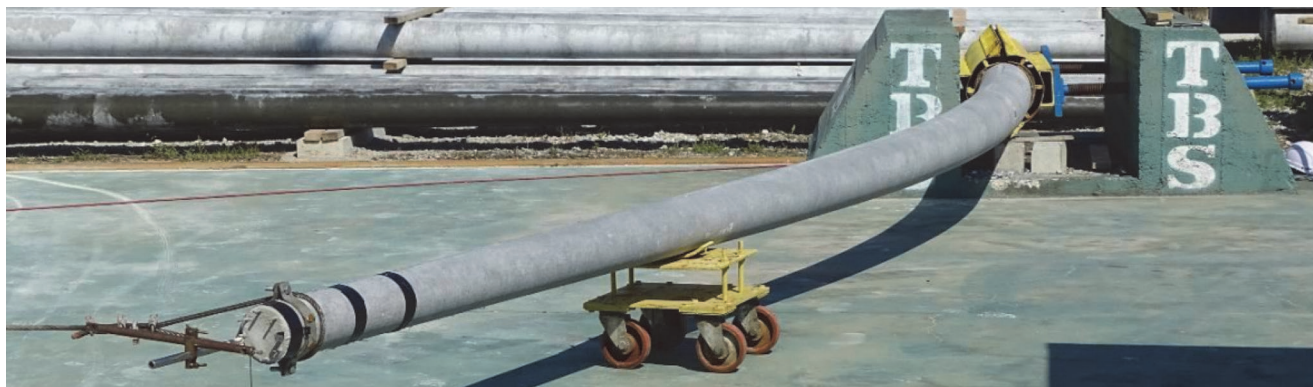
Slika 15. Ispitivanje nosivosti – uzorak 7/8 – pomak neposredno prije sloma
